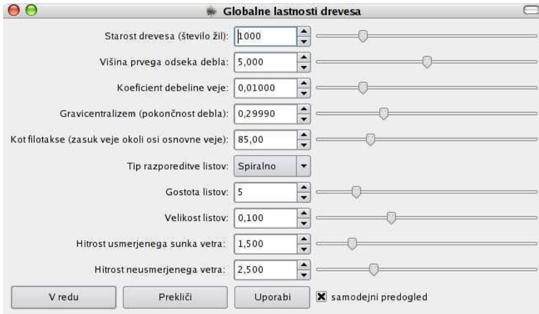
Slika 3.4: Pogovorno okno za interaktivno nastavljanje globalnih parametrov parametričnega modela drevesa. Ob sprememjanju parametrov se takoj osveži tudi prikaz drevesa.
